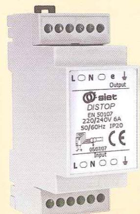
Protezione esterna contro dispersioni a terra del circuito di AT, in conformità alla norma EN50107. Questa versione permette di collegare più trasformatori fino ad un carico massimo di 6A o oltre tramite teleruttore ed è obbligatoria qualora si utilizzano sistemi di dimmeraggio e/o animazioni.
