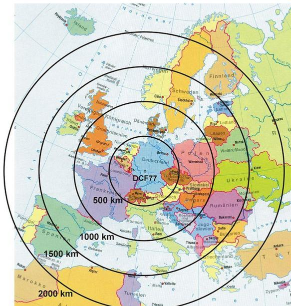
Fig. 3 – Raggio d'azione del segnale radio DCF 77
